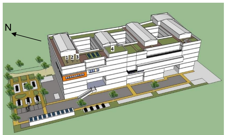
Figure 3 : position des capteurs sur le toit ; au R+6 : 1 = mât météo, 2 = disdromètre, 3 = caméras réseau ; au R+7 : 4 = anémomètre 3D
