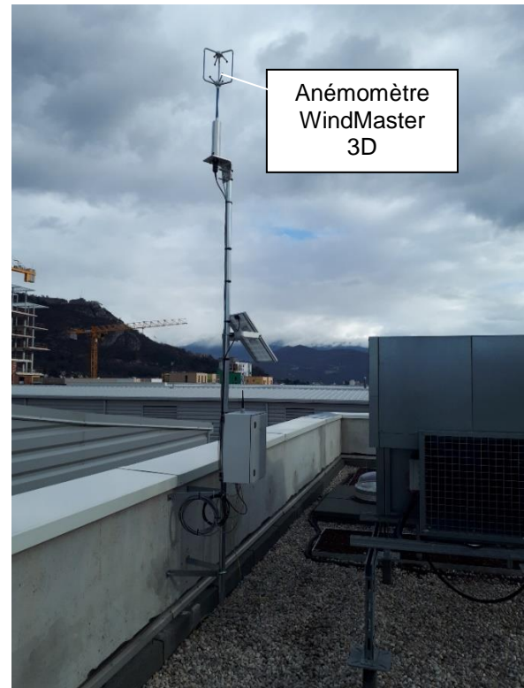
Figure 30 : mât Anémomètre R+7 depuis avril 2018
